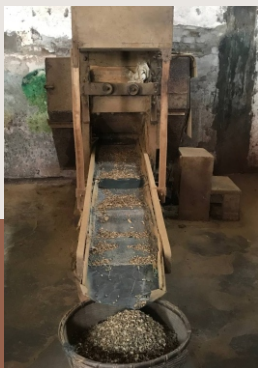
■ Mesin penggiling klembak
